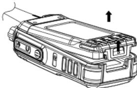
**注：请勿在对讲机处于开机状态下插、拔电池。**
