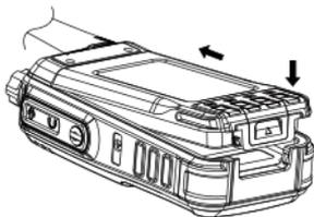
欲取下电池，请先关闭对讲机电源，然后将对讲机背面底部的门锁向上推，将整块电池往上提取出电池。
