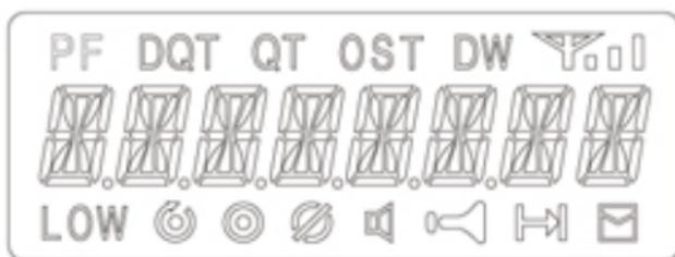
**PF:** 编程显示符号，编程进入各项设置功能时显示闪烁，设置参数完毕退出编程状态后PF消失。
